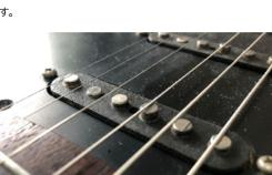
一つだけポイントですが、ストラトのピックアップは、ポール部分が弦により高さが調整してありますが、こちらは新しいFenderのピックアップも、取り付け方向が取説で明確に指示されてますので大丈夫です。作業自体は、さすがFenderのコピー品だけあり、ピックアップの取り付けも、ネジ穴を少々広げるくらいの調整でOKです。ポットもミリ規格からインチ規格に換えたためか、ピックアップ部分を若干リマーで広げましたが、こちらも簡単な作業でした。
