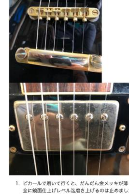
1. ピカールで磨いて行くので、だんだん金メッキが薄くなり、銀色に変わって行くのが分かったため、完全に表面仕上げレベル迄磨き上げるのは止めました。これでもザラザラした感触はなくなっています。
