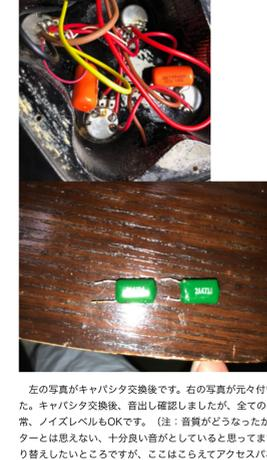
左の写真がキャパシタ交換後です。右の写真が元々付いていたキャパシタで、その容量は0.047uFでした。キャパシタ交換後、音出し確認しましたが、全てのポットとピックアップのセレクトスイッチとも正常、ノイズレベルもOKです。（注：音質がどうなってるかは聞かないでください。気持的には3,000円のギターとは思えない、十分良い音かと思っています。）配線とハンダ付けの汚さに耐えられず、全量り替えたいところですが、ここはこらえてアクセスパネルを閉じました。（ちなみに、下2つのポットのトーン回路周りはKanattec配線、上2つのポットのボリューム周り配線はオリジナルです。）
